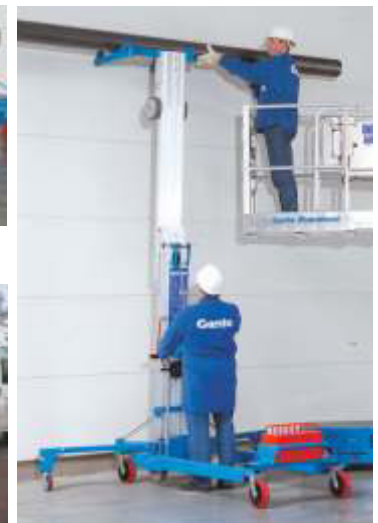
Wienold SuperLift mit Kontergewichten: SLK Umgebauter SLA mit Kontergewichten. Gabel und Ausleger sind gegenüberliegend, wodurch der SLK ideale Bedingungen für die Montage von Lasten bis 300 kg direkt an Wänden bietet.
