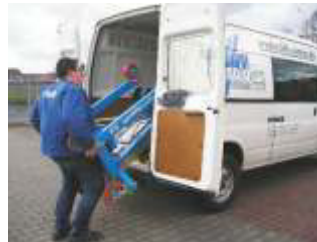
Wienold SuperLift mit Kontergewichten: SLK Umgebauter SLA mit Kontergewichten. Gabel und Ausleger sind gegenüberliegend, wodurch der SLK ideale Bedingungen für die Montage von Lasten bis 300 kg direkt an Wänden bietet.
